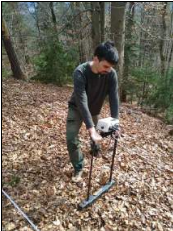
Sl. 47: Gradišče-Stari grad Repnje. Geoelektrično kartiranje z instrumentom Geoscan RM15 (foto: Ž. Špendal).
