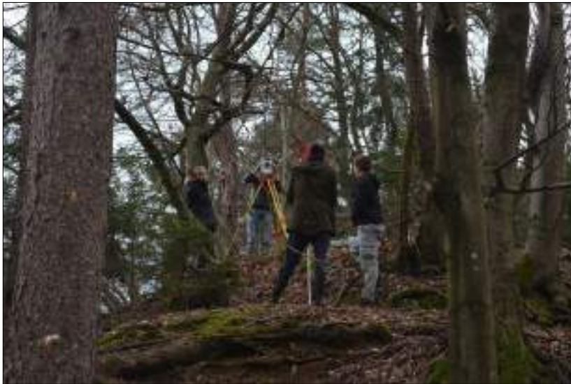
Sl. 11: Gradišče - Stari grad Repnje. Meritve s totalno postajo na severnem delu vršne ploščadi (DSC_6783; 2. 3. 2020; foto: A. Gaspari)
