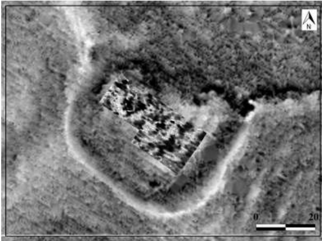
Sl. 49: Gradišče-Stari grad Repnje. Rezultati magnetnih meritev z magnetometrom G-858 na gradientni način za različne razpone prikazanih magnetnih gradientov v sivih odtenkih na ZLS posnetku (podlaga: gisportal RKD; geodetska izmera: A. Gaspari, M. Vinazza 2020).
